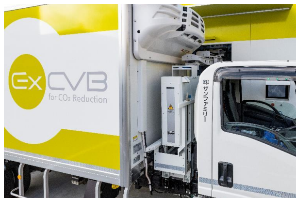
(左上) バッテリー交換ステーションとバッテリーパック（撮影用動作） (右上) バッテリー交換式小型 EV トラックと太陽光パネル (左下) バッテリー交換ステーションにてバッテリーパック（キャブと架装の間）を交換中
