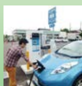
電気自動車用 急速充電器
