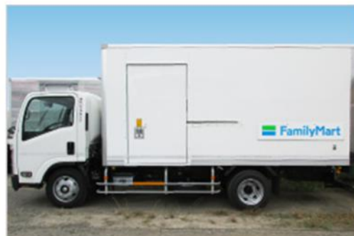
「定温室」と「チルド室」2つの温度を変えた部屋を搭載した2室式車両
