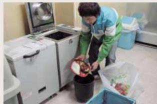
弁当などの容器包装を外し、中身を処理機の中容器に投入。最大5kgまで投入可能です
