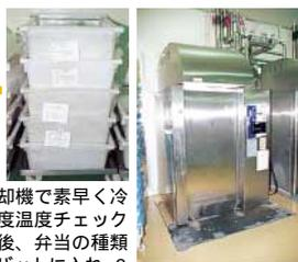
真空冷却機で素早く冷却。再度温度チェックをした後、弁当の種類ごとにパットに入れ、3~8度の冷蔵庫で保管
