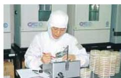
製造後には、毎日各ロットごとに製品を抜き取り、品質管理室で担当者が細菌検査を実施。検体は冷凍庫で2週間保管している
