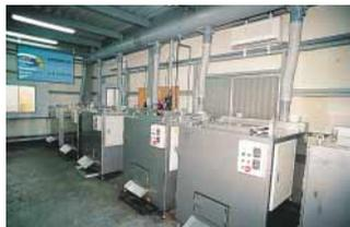
処理施設で稼働している生ゴミ処理機。種菌とともに熱を加えながら24時間攪拌すると、肥料原料となる
