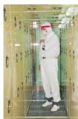
製造現場に入るには白の作業服、帽子、マスクを装着、粘着ローラーで付着物を取り除き、手を除菌し、さらに約10秒間エアシャワーを浴びる
