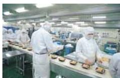
ベルトコンベアの流れ作業によるトッピング。ご飯・メインのおかず・添え物・ふた(容器)の順で行われ、各工程で不適当なトッピングは修正される
