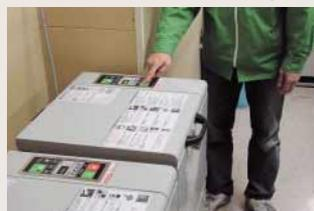
ふたをして、スイッチを押せば、処理開始。5kgの処理時間は約80分です
