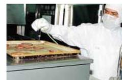
加熱調理後に抜き取り検査を行い、規定温度(細菌が死滅する温度)に達しているかを確認
