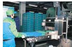
使用後の空パレットはすべて洗剤と軟水の蒸気で洗浄・消毒
