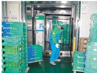
定温庫(室温18℃に維持)で、車輛後室に冷蔵商品(弁当、おにぎりなど)を積み込む。弁当は上にある製造工場から下りてくるので、製造から納品までの時間が短縮される。日用品を共配する便では、この後室に日用品も積み込む
