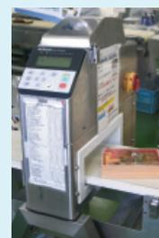
金属探知機を設置し、チェックしています。万一、金属混入が認められたときは、ベルトコンベアが自動的に停止し、チェックの上、排除します。
