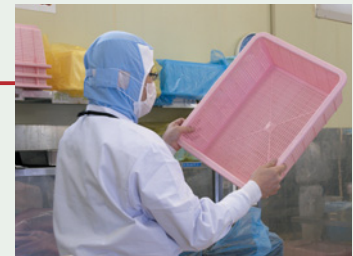
ザルに破損がないかを点検します
