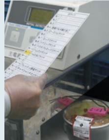
金属検出機は、製品に応じて適切な設定が行われているか、設定一覧表を点検します
