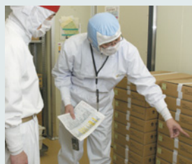
箱に貼られた「入荷日票」の確認。原材料は日付の古いものが上にくるようにして積むのが、「先入れ先出し」の基本
