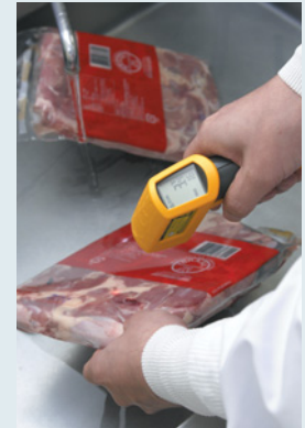
流水で解凍中の生肉の表面温度を照射温度計で計測して温度上昇がないか点検します
