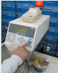
テストピースを使い、金属検出機の設定と反応を点検します
