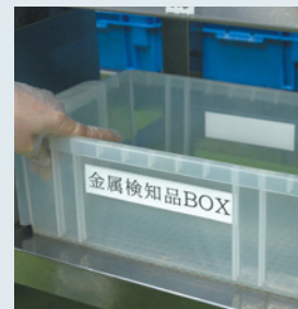
金属検出機で反応した製品があった場合に保管する専用BOXを設置。反応した製品は直ちにライン責任者が再検査を実施します
