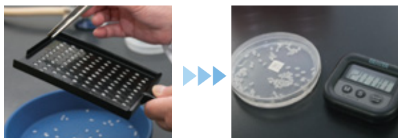
入荷米を水に浸し、割れの発生率を調べる「水浸割粒」検査
