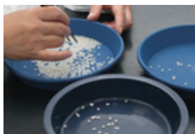
入荷米における未熟米や割れた米の比率を調べる「粉状」「着色」「砕粒」検査
