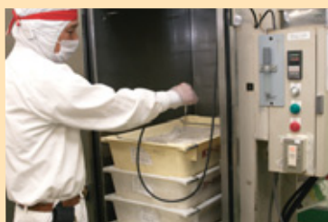
冷却した炊飯米の温度検査。炊き上がったごはんは真空冷却装置へ入れて、中心温度が25℃以下になるまで冷却する。
