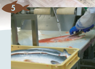
機械で3枚におろした後、胸の骨を取り除く
