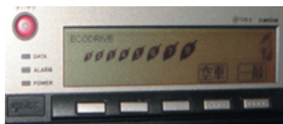
EMSの画面（葉っぱの数が多ければエコドライブ中）。ドライバーは、この画面を見て運転状況を確認できる。
