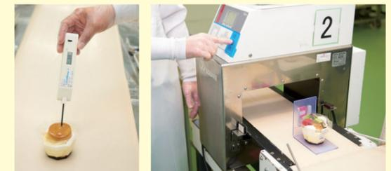
プリン(サンプル)の芯温チェック。完成品を金属探知機に通す前に作動確認。
