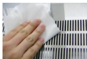
フィルター清掃の様子
