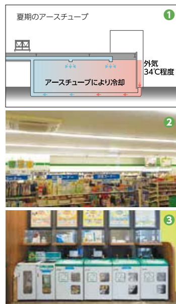
①ユニー：クール・ヒートトレンチの構造 ②ファミリーマート：店内のLED照明 ③ユニー：リサイクルステーション
